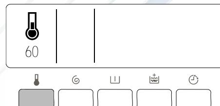
Нажимайте последовательно кнопку “Температура” ( ), чтобы повысить или понизить температуру в случае, если необходимо стирать при температуре, отличной от той, которая была выбрана стиральной машиной. Символ ( )\* соответствует стирке в холодной воде.
