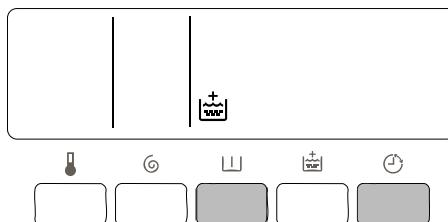
Нажмите в течение нескольких секунд кнопки “Предварительная стирка” и “Задержка пуска” . Функция окажется включенной постоянно, даже при отключении прибора от электросети. Для отключения функции повторите ту же процедуру.
