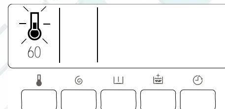
В процессе выполнения цикла происходит изменение символа ━ при нагревании прибора.
