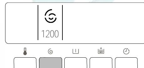
Нажимайте последовательно кнопку “Отжим” ( ), чтобы повысить или понизить скорость отжима в случае, если необходимо выполнить отжим белья на скорости, отличной от той, которая была выбрана стиральной машиной. Можно также выбрать один из следующих вариантов: “Без отжима” ( ), “Остановка с водой в баке” ( )\* или “Ночной режим плюс” ( ).
